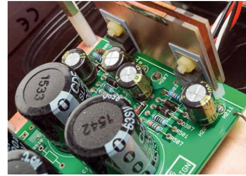
Jeder Kanal wird über eine eigene Vorreglerplatine versorgt
